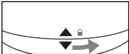
**D Inbetriebnahme:** Batteriefachdeckel aufdrehen. 2 AAA-Batterien entsprechend der Markierung einlegen. Batteriefachdeckel wieder aufsetzen, auf richtige Ausrichtung achten.
